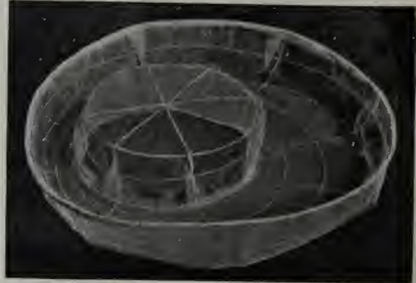
Les laitons doivent tous se rejoindre derrière sur la même ligne afin que la forme ne présente aucune irrégularité dans ses contours.
